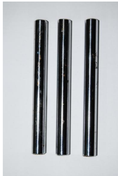
Foto 6 Cromo Duro después de 72h NSS (muestras limpias)
