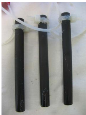
Foto 7 Probetas ARCOR V después de 64h CASS (muestras sin limpiar)
