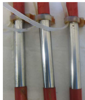
Foto 8 Probetas Cromo Duro después de 64h CASS (muestras limpias)
