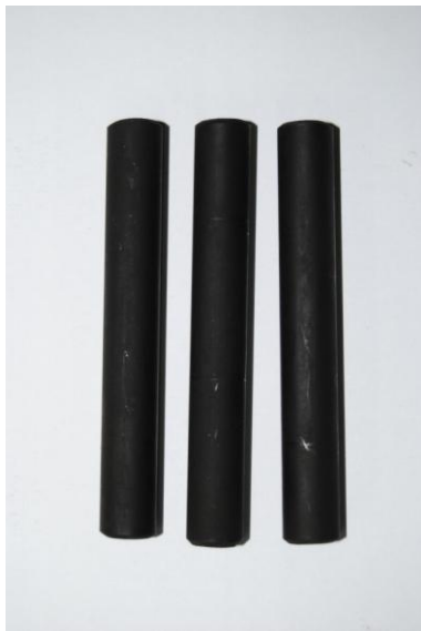
Foto 5 ARCOR V después de 408h NSS (muestras limpias)
